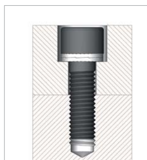
沉孔中的内六角螺栓被安全定位
