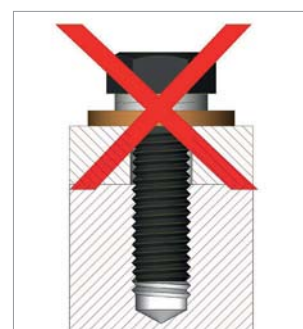
叠加可自由转动的平垫导致防松功能丧失
